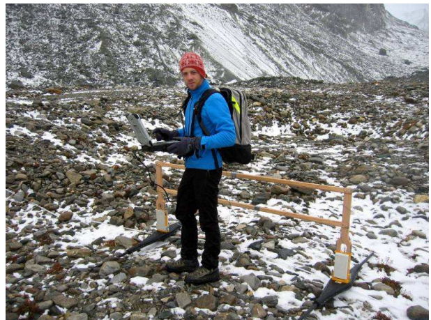
Foto 1: Georadarmessung im Gletschervorfeld der Pasterze.
