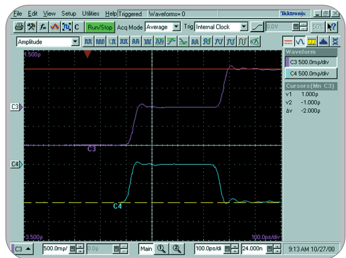
► Abbildung 21. Zeitbereichs-Reflektometrie-Darstellung (TDR) eines TDS8000 Digital-Sampling-Oszilloskops mit dem 20-GHz-Sampling-Modul 80E04
