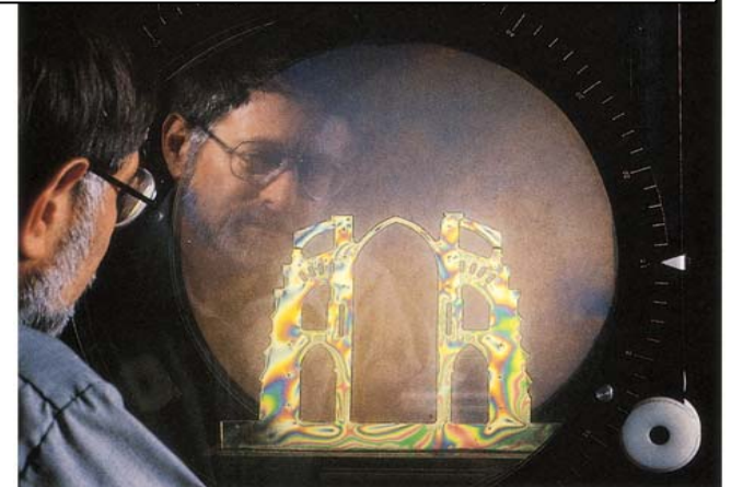
Spannungsmuster an einem Modell des Mittelschiffs der Kathedrale von Chartres
