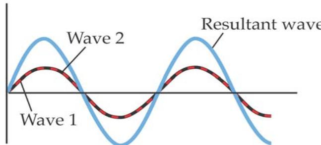
$$\delta = 0 \Rightarrow \Delta x = 0 \Rightarrow \text{konstruktive Interferenz}$$
