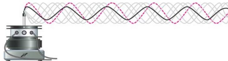
Frequenz des Vibrators ist nicht in Resonanz mit einer der Eigenfrequenzen der Saite  $\Rightarrow$  keine Amplitudenüberhöhung
