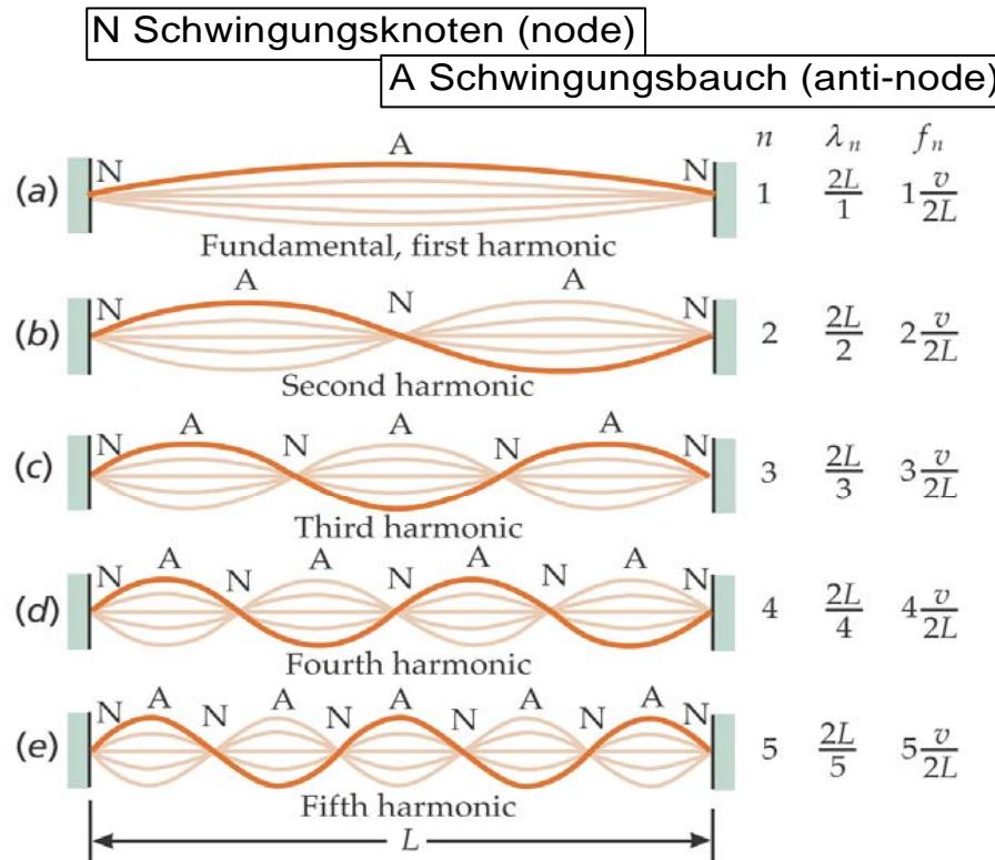
Bedingung für stehende Wellen für eine beidseitig eingespannte Saite
