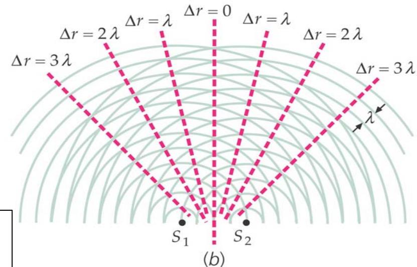
Intensität der Welle resultierend aus der Überlagerung von zwei gleichphasigen Wellen mit der jeweiligen Amplitude  $A_0$
