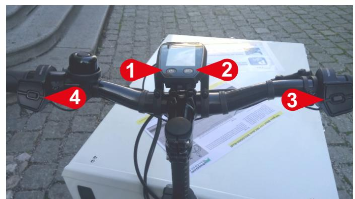
Mögliche Fehlermeldungen: E012 bedeutet, daß der Antriebssensor nicht funktioniert. Dieser Fehler kann einfach behoben werden indem bei Stillstand des Rads und ohne Belastung eines Pedals die Steuerung aus/eingeschaltet wird. Weitere Details zur Steuerung und auch Fehlercodes sind im Manual auf der Website [www.uni-salzburg.at/mobilitaetsmanagement](http://www.uni-salzburg.at/mobilitaetsmanagement) verfügbar.
