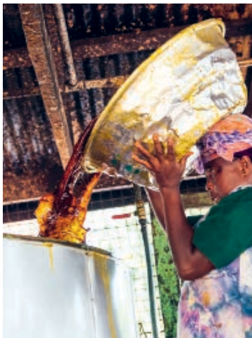
Auf dem Kopf balanciert gelangt das Öl-Fruchtfleisch-Gemisch aus der Presse in den Ofen zur Reinigung.
