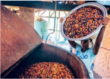
Palmfrüchte lassen sich nicht einfach pressen wie Oliven. Sie müssen erst zwei Stunden gedämpft werden.
