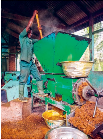
Die Ölpresse spuckt ein Abfallprodukt aus: ein Gemisch aus Fasern und Kernen, die weiter verarbeitet werden.
