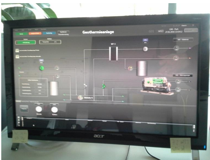
Die Abbildung oben zeigt einen Bedienungsbildschirm unseres Gebäudemanagements zur Steuerung der Geothermieanlage am Standort Unipark.
