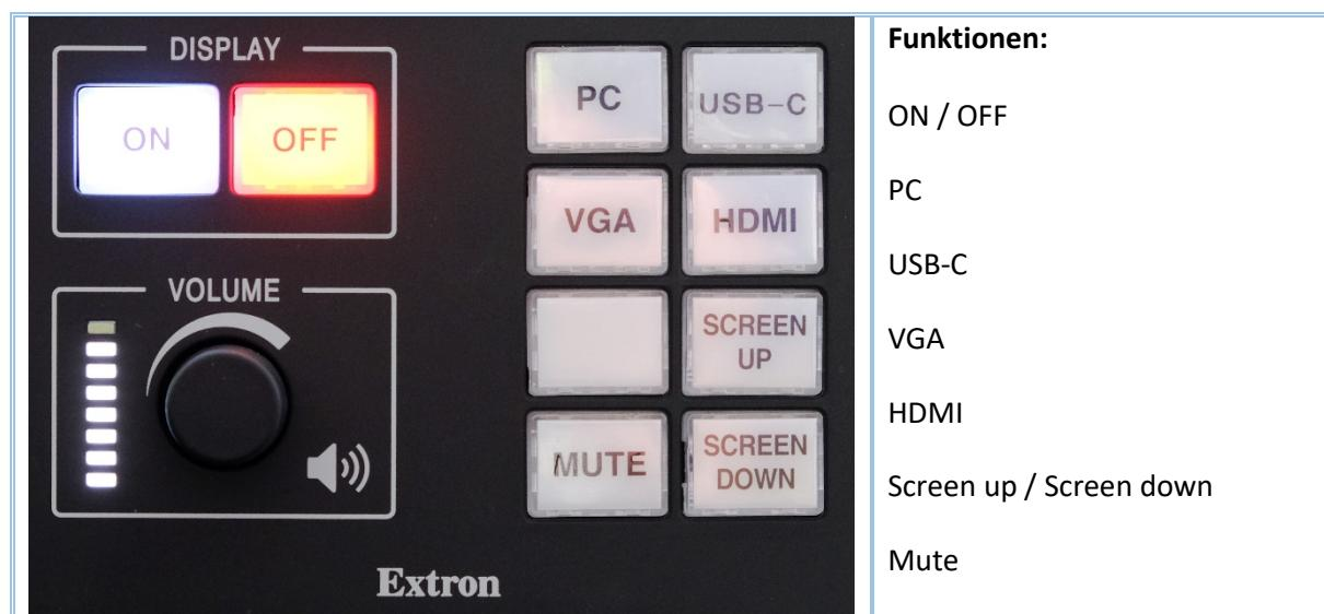
**ON Taste:** hiermit schalten Sie den Projektor ein und die Leinwand fährt herunter, der Button leuchtet rot im aktiven Zustand
