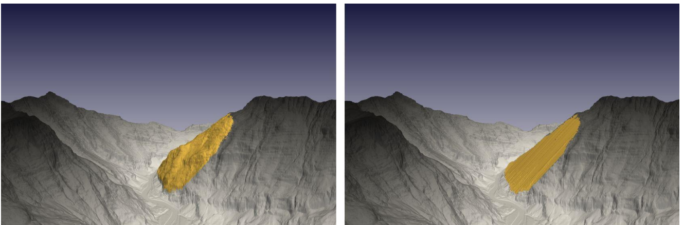
Grafik: Perspektivische Darstellung einer typischen Gebirgslandschaft in den Kalkalpen (hier Salzachtal südlich des Pass Lueg). (a) der farbige Bereich stellt eine potentielle Sturzmasse dar, die mit einem numerischen Hangstabilitäts-Verfahren bestimmt wurde. (b) Dieselbe Topographie nach Entfernung der potentiell instabilen Sturzmasse. | Modellierung und Visualisierung: © Jörg Robl
