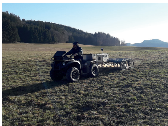
Das motorisierte Sensors & Software-Bodenradarmessgerät im März 2022 in Mattsee Schalkham im Einsatz. ZAMG (Archeo Prospections)
