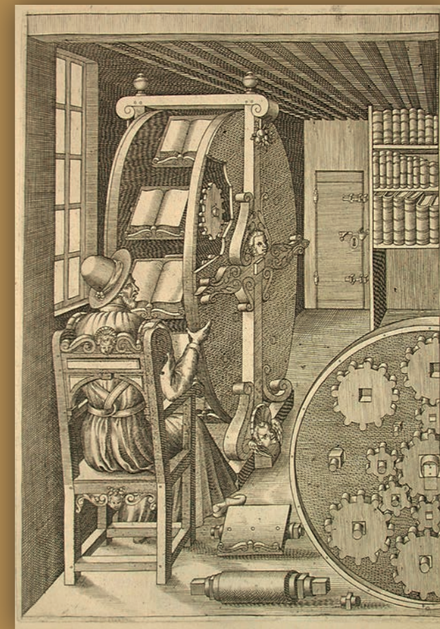
Das Bücherrad, aus: Agostino Ramelli: Le diverse et artificiose machine, 1588
